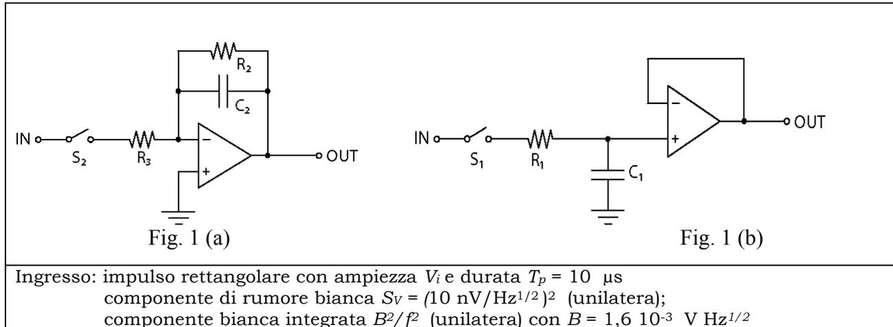
Da una sorgente a bassa impedenza (sensore e preamplificatore) provengono segnali di cui occorre misurare l'ampiezza. Il tempo di arrivo di ogni segnale è indicato da un segnale ausiliario di sincronismo. Per la misura si utilizzano i filtri lineari commutati indicati in Fig. 1. È possibile anche complementare questi filtri con altri circuiti lineari, se lo si ritiene utile per migliorare la misura.
