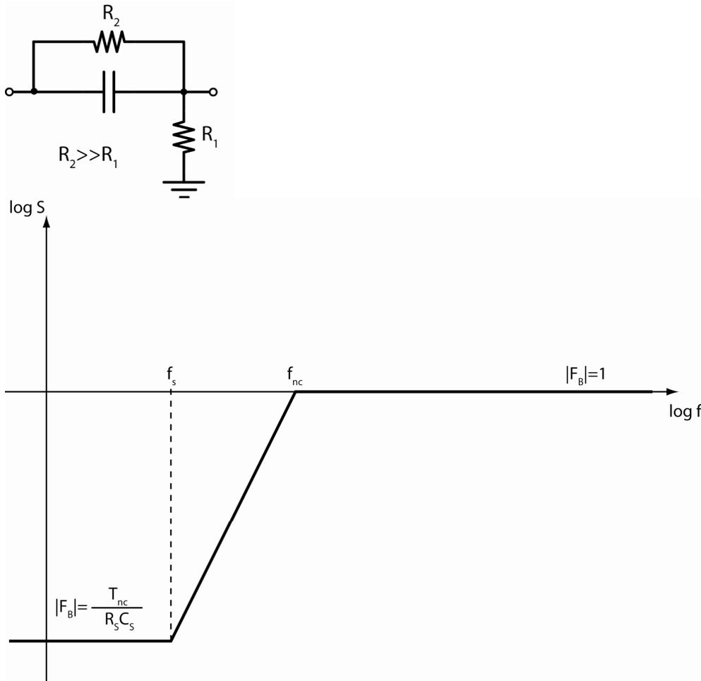
Diagramma (asintotico) di Bode del filtro sbiancante ricavato tenendo conto di  $R_S$  finita.
