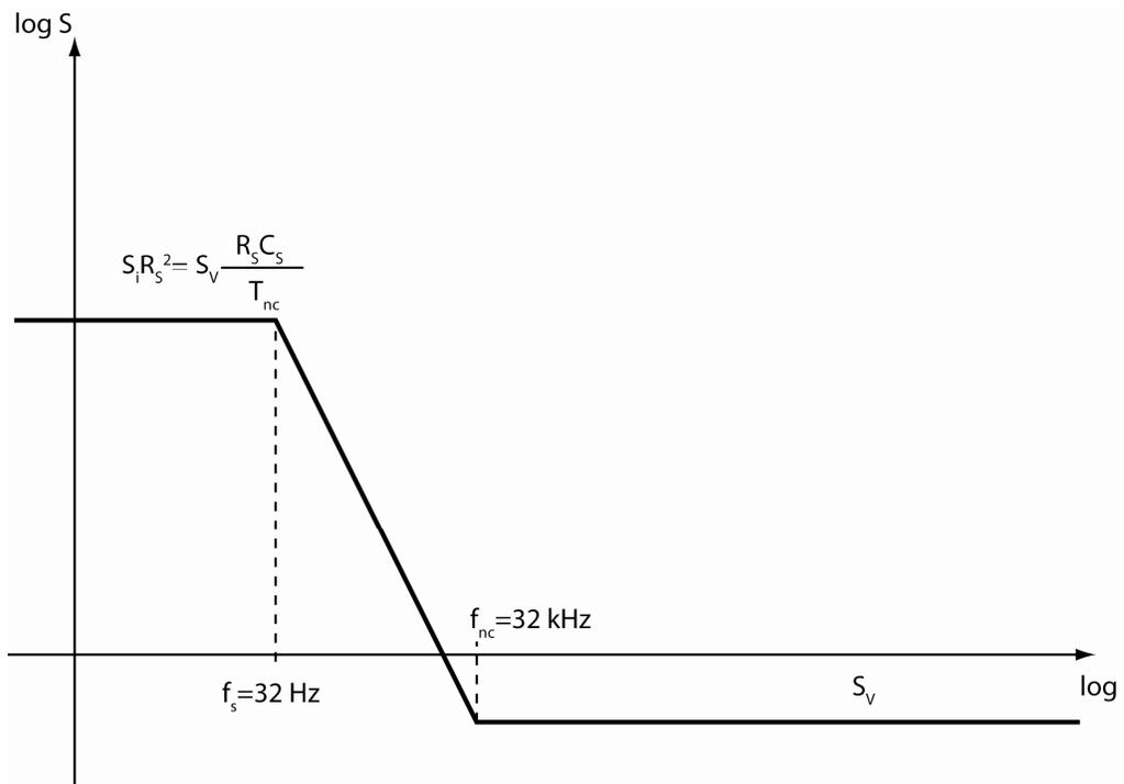
Diagramma (asintotico) di Bode del rumore con  $R_S$  finita.
