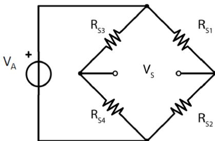
Si utilizzano dispositivi standard (coppie di strain gauges su uno strato di supporto, disposti ortogonali per la compensazione degli effetti termici) e si dispongono in configurazione a ponte di Wheatstone in modo che
