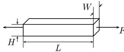
dove  $L$  è la lunghezza e  $S = W \cdot H$  è la sezione. Definiamo sforzo (stress) il rapporto tra la forza applicata e la sezione del corpo ( $N = \frac{F}{S}$ ), e deformazione (strain) la variazione relativa di lunghezza ( $\varepsilon = \frac{\Delta L}{L}$ ). Se il materiale è elastico la deformazione è proporzionale allo sforzo:
