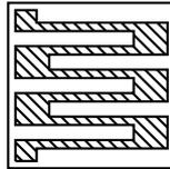
e sono quindi sottili ( $2\ \mu\text{m} \div 10\ \mu\text{m}$ ) e con tratti trasversali larghi in modo da avere  $\frac{G_T}{G_P} \simeq 0,1\%$ . Altri vantaggi degli strain gauges litografici sono:
