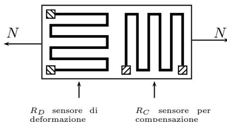
Uno schema per la compensazione termica nel ponte di Wheatstone è:
