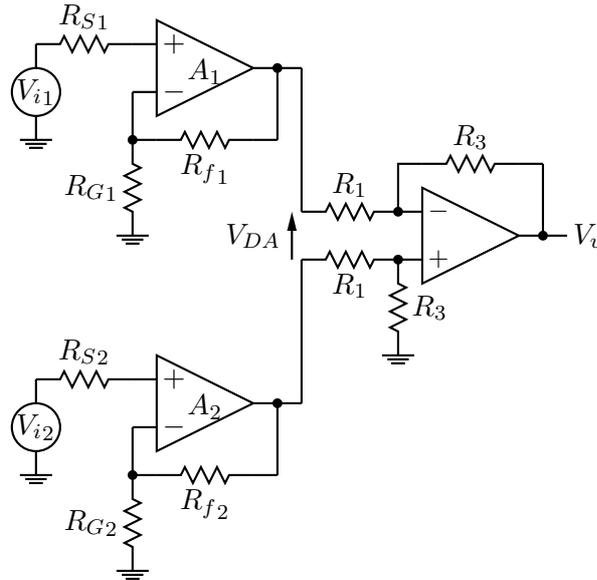
Il guadagno  $G_{DA} = \left(1 + \frac{R_{f1}}{R_{G1}}\right) \simeq \left(1 + \frac{R_{f2}}{R_{G2}}\right)$  del primo stadio agisce sul segnale differenziale, ma anche su  $V_{CM}$ . Dato che  $V_{CM}$  è, di solito, elevato, i limiti di dinamica impongono valori limitati di  $G_{DA}$ .
